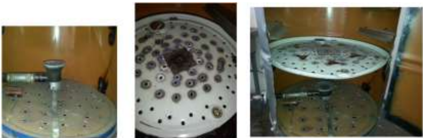
Figura 11. Quemador de gas y tapas de lámina agujeradas del equipo de secado.
