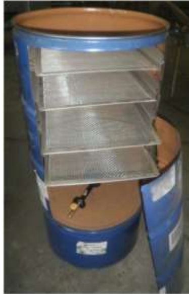
Figura 10. Unión del tambo completo y medio tambo para formar una sola pieza.
