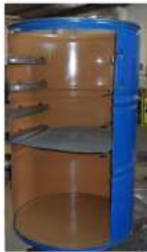
Figura 9. Colocación de parrillas de acero inoxidable en la cámara de secado.
