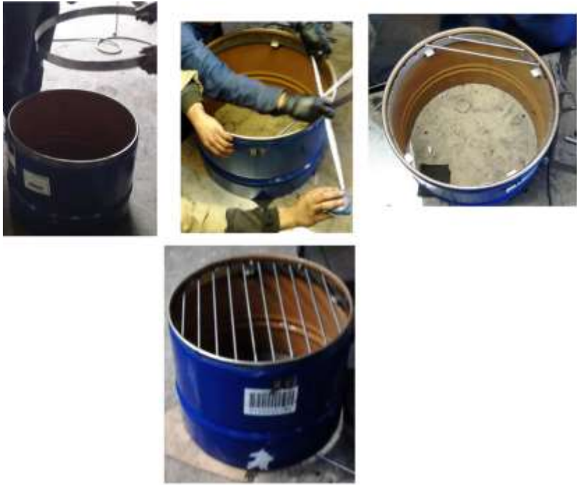
Figura 20. Colocación del aro y varillas de acero inoxidable en el medio tambo.
