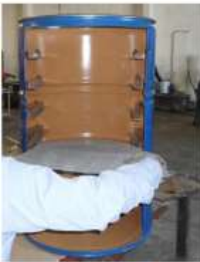
Figura 9. Colocación de parrillas de acero inoxidable en la cámara de secado.
