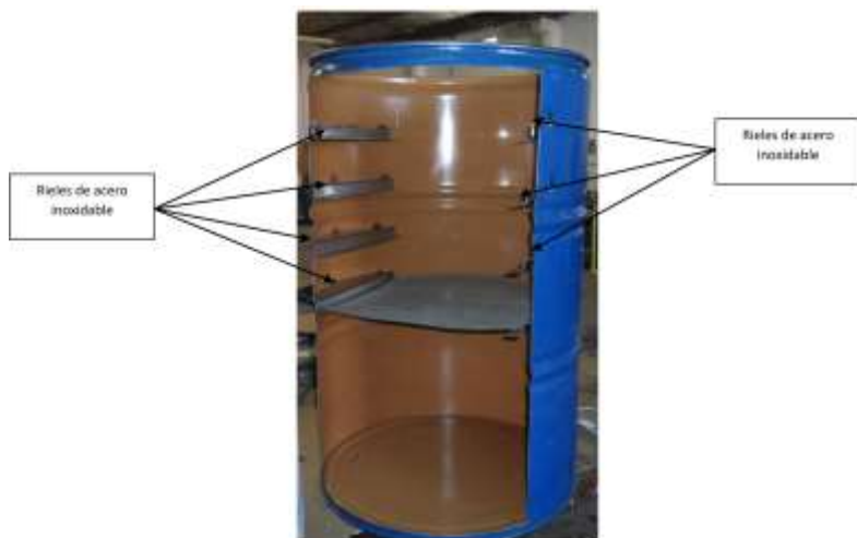
Figura 5. Corte para la puerta y colocación de rieles de acero inoxidable de secador de carne.
