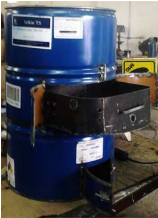
Figura 26. Colocación de la charola de lámina negra en el horno-ahumador.
