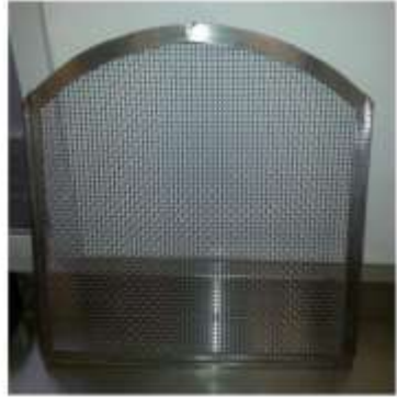
Figura 8. Parrilla de malla de acero inoxidable del secador de carne.
