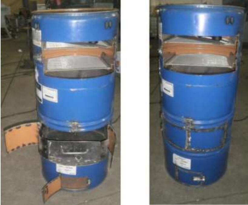
Figura 27. Unión del tambo completo y medio tambo del horno-ahumador.
