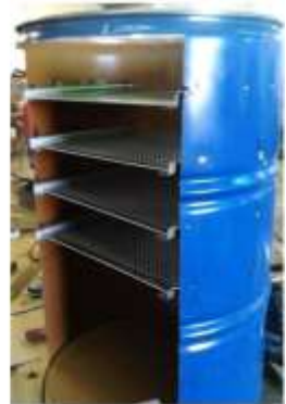
Figura 9. Colocación de parrillas de acero inoxidable en la cámara de secado.
