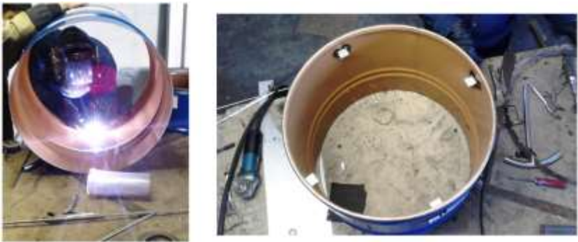
Figura 19. Soleras que soportan el aro de acero inoxidable.
